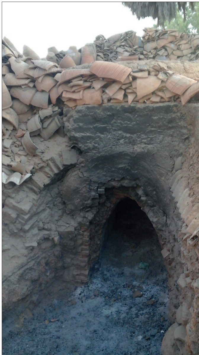
Рис. 6. Печь для обжига гончарных изделий. В качестве топлива используют дрова. (Фото автора. 2020).
